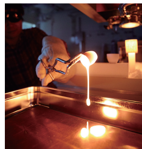
1400℃を超えるような融液を金属板上で急冷し、ガラスを作製します。このようにして作製した試料を用いて、熱伝導率、粘性、結晶化、構造などの評価を行っています。
