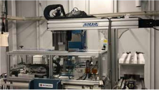
図 3 ミリ秒オーダー時間分解能の試料高速回転 4D X 線 CT 装置 (試料オートチェンジャーによりハイスループット撮影が可能)
