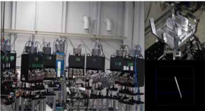
図 2. 試料回転なしサブミリ秒時間分解能 4D X 線 CT のためのテーブルトップ型マルチビーム光学系の写真 (左) および光学素子 (右上) と原理実証の結果 (タングステンワイヤーの三次元 CT 再構成像) (右下)
