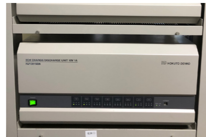
定電流充放電装置
