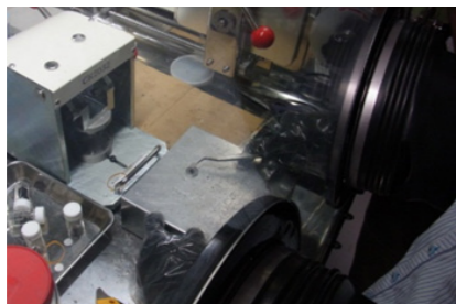
グローブボックス内で全固体リチウム電池を作製している様子
