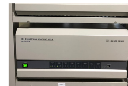
定電流充放電装置
