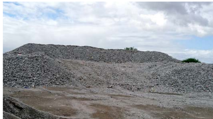
ケープタウン近郊の解体コンクリートの破砕片の発生の様子
