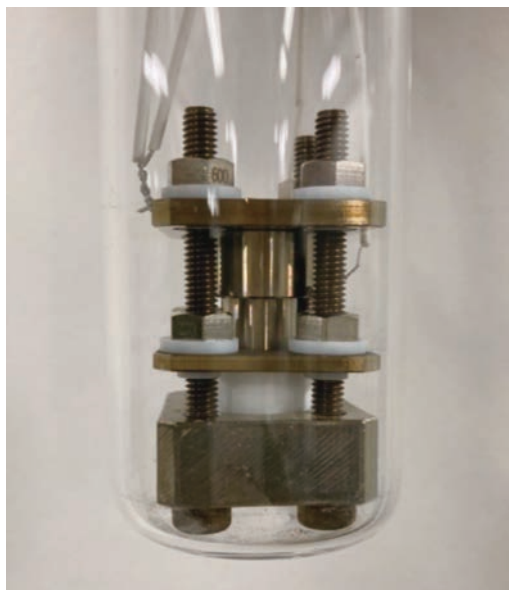
固体電解質リアクター試作機の写真。小型の試作機を使って研究コンセプトの実証を進めています。
