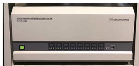
定電流充放電装置
