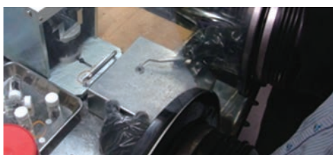
グローブボックス内で全固体リチウム電池を製作している様子
