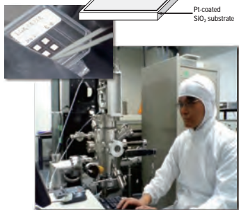
レーザー蒸着法で作製した薄膜リチウム電池
