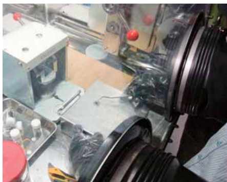
グローブボックス内で全固体リチウム電池を作製している様子
