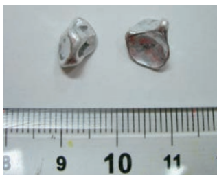
図1 ITOと窒化リチウムとのメカノケミカル反応で回収したインジウムとスズ
