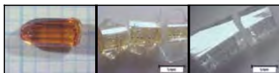
酸素分圧 → 高 酸素分圧制御—化学気相成長法による高品位 ZnO 単結晶
