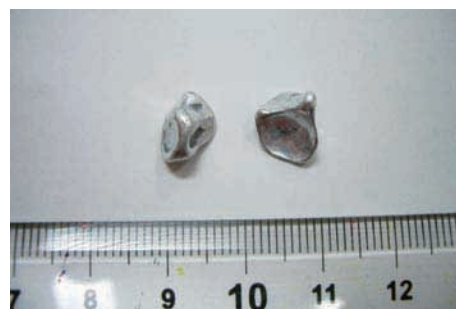
図1 ITOと窒化リチウムとのメカノケミカル反応で回収したインジウムとスズ
