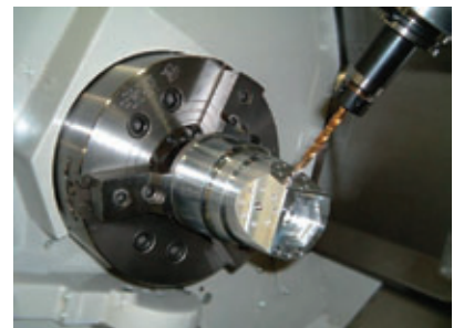
複合加工機による斜面への穴加工
