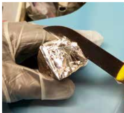
金属Naや構成元素にNaを含む化合物の多くは大気中では不安定なため、酸素や水分を極力排除した不活性雰囲気の中で満たされた「グローブボックス」の中で取り扱い、試料の特性評価も行います。
