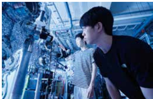
真空薄膜装置。真空チャンバー内で高電圧を加え、発生したイオンをターゲット材料に高速で衝突させると、材料原子が叩き出されて基板に薄く堆積し薄膜を形成します。
