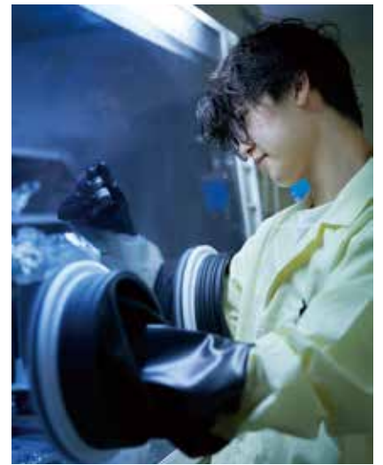
酸素を嫌う物質を、グローブボックスという特別な雰囲気中に制御した装置の中で取り扱っています。
