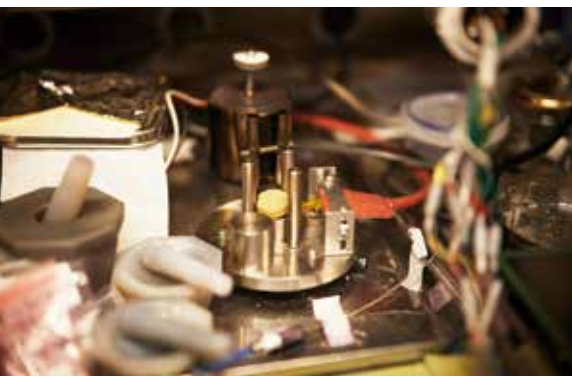
金属Naや構成元素にNaを含む化合物の多くは大気中では不安定なため、酸素や水分を極力排除した不活性雰囲気の中で満たされた「グローブボックス」の中で取り扱い、試料の特性評価も行います。
