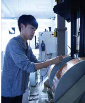
磁化測定装置。測定原理自体は電磁誘導の法則とシンプルでありながら、ナノメートル厚みの磁性薄膜の磁化を高感度に測定できます。
