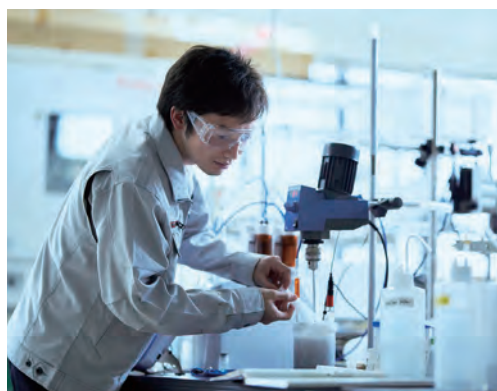
電位差測定装置を用いて、溶液内の目的成分の濃度を2電極の電位差から情報を得る分析手法です。溶液中のイオン濃度や酸化還元電位の測定に利用します。
