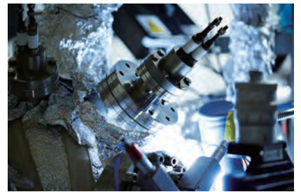
虻川研究室では様々な回折装置などをほぼオリジナルで製作しています。写真は電子回折装置の一部。アルミホイルは超高真空排気時に装置全体を均一に加熱するため。
