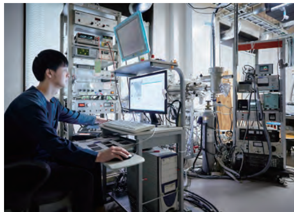
超高真空の数値や、試料温度、電子の反射位置測定など様々なモニタリングを行いながら、電子回折装置で得られたデータを解析して表面構造を探索していきます。
