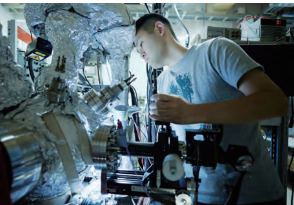
固体表面の構造を探索する電子回折装置。試料に電子を当て、その反射によって表面構造を解析します。余計な大気分子などを完全に排除した超高真空環境の中で、加熱、スパッタ、真空蒸着などによって目的の表面を作って観測します。
