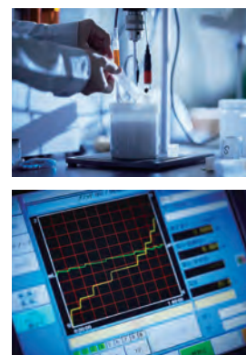
電位差測定装置を用いて、溶液内の目的成分の濃度を2電極の電位差から情報を得る分析手法です。溶液中のイオン濃度や酸化還元電位の測定に利用します。
