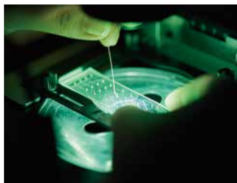
イメージセンサーの視野に収まる範囲であれば多サンプルの同時測定も可能。火原教授は東京工業大学勤務時代に世界で初めて同時蛍光偏光測定に成功した。
