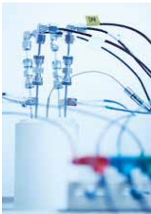
インピーダンス測定装置。酸化半導体について重要な機能をはたす導電性の測定などを行います。
