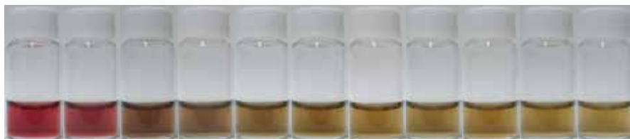
Au100Pt0 Au90Pt10 Au80Pt20 Au70Pt30 Au60Pt40 Au50Pt50 Au40Pt60 Au30Pt70 Au20Pt80 Au10Pt90 Au0Pt100 塩化金酸と塩化白金酸の混合溶液にレーザー光を照射すると、両者の合金微粒子が生成されます。混合溶液中の金と白金の割合に応じて、自由に合金の組成を変えることができます。全率固溶の合金が得られ、燃料電池用等の触媒への応用が期待されています。
