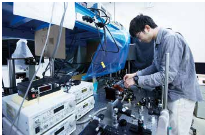
再生増幅器によって得られるフェムト秒レーザーパルスを回折限界近くまで絞り込むと、10の16乗W/cm 2 あるいはそれ以上の強度を得ることができます。高強度のレーザー場によって、新たなシングルナノ微粒子の製作プロセスを生み出すことに佐藤研究室では取り組んでいます。
