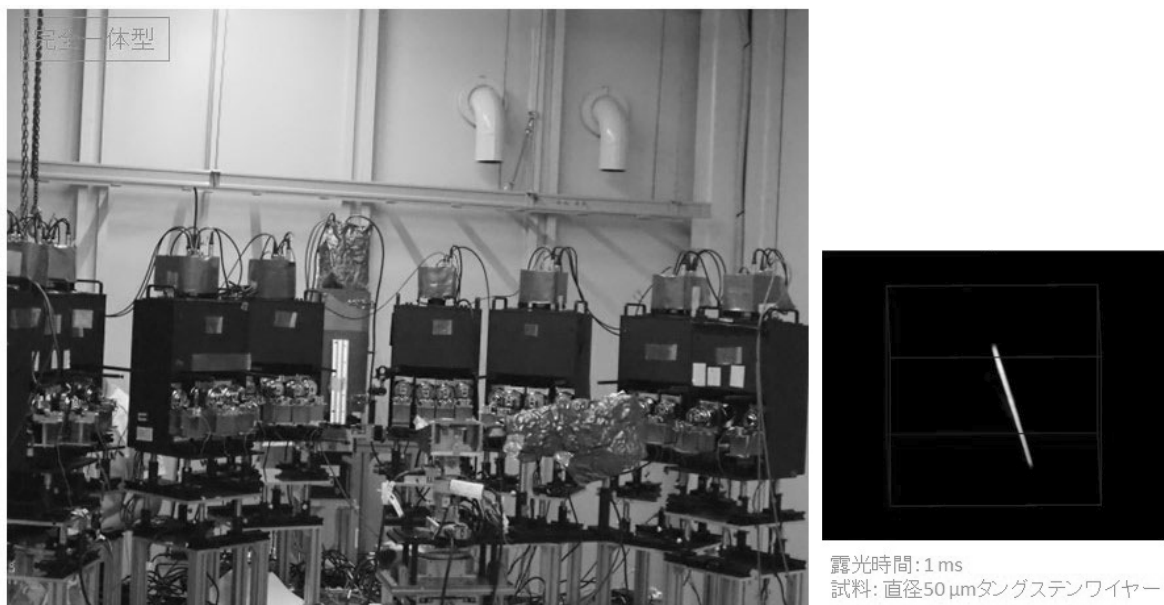
図 1 . 3 GeV 高輝度放射光施設 NanoTerasu の BL09W に立ち上げた一体型マルチビーム光学系ベンチの写真(左)と，この光学系による CT 撮像例(露光時間 1 ms)(右)．
