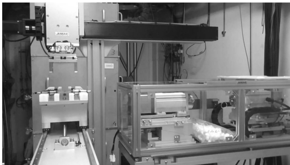
図2 非平衡系マテリアルズ・インフォマティクスのための試料自動交換 4DX 線 CT 装置の写真。
