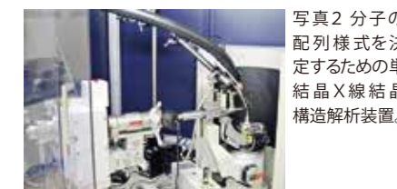
写真2 分子の配列様式を決定するための単結晶X線結晶構造解析装置。
