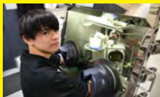
大気に触れさせたくない材料は、グローブボックスという酸素や水蒸気に触れない箱の中で取り扱います
