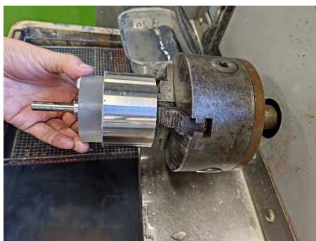
図 2. 治具を使用した研磨の様子
