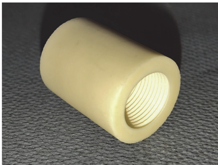
図1 製作したアルミナめねじ
