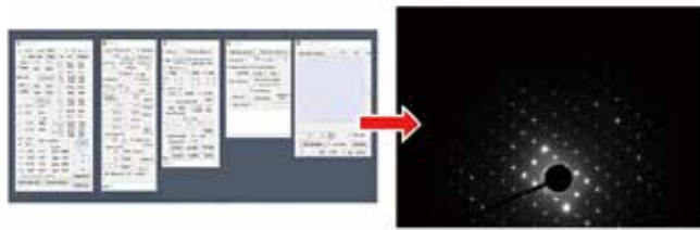
開発したシステムParallEM (左)とそれを用いて測定した機能性材料の回折パターン(右) (Takaba et al., J. Struct. Biol., 2020).
