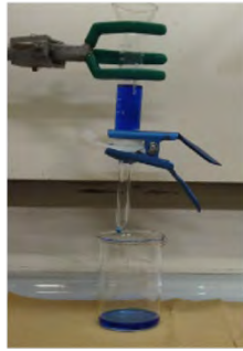
図 4. 濡れ性制御による油水分離(左:油に濡れる表面・右:水に濡れる表面)
