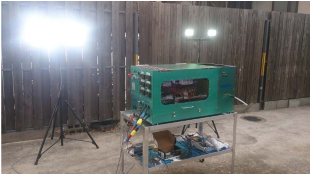
図5 ZnO コーティングベアリングを搭載した災害用小型ジェットエンジン発電機 (当該発電機で発電した電力でライトを点灯している様子)
