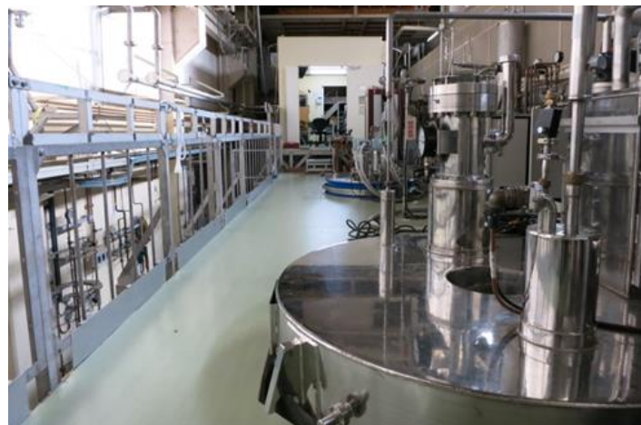
強磁場センターの実験室例。 手前は30Tハイブリッドマグネット。奥の青いマグネットが28T無冷媒ハイブリッドマグネット。
