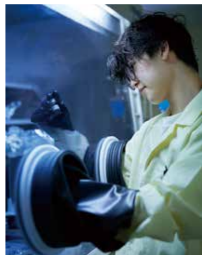
酸素を嫌う物質を、グローブボックスという特別な雰囲気の中で取り扱っています。
