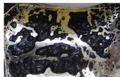
作製した模擬デブリの一例。加熱前は粉末状だったが、加熱することで溶解し、黒い塊のような物質に変化します。
