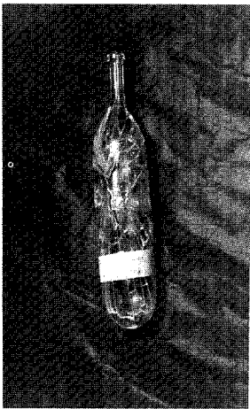
図3 試験管の脆壊例 外径50 mm, 内径43.6mm, K = 1.36 破壊圧 3.8\text{kg/cm}^2
