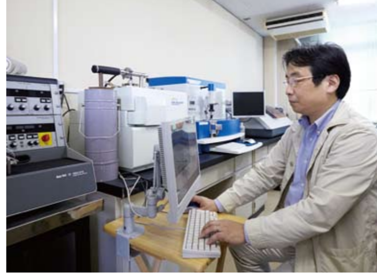
電子顕微鏡とは、光学顕微鏡では見えない微細な物質の像を見えるようにする機器。直接そのものを見るというよりは、物質に電子をあて、そこから出てくる様々な信号を取り出し、そのデータを解析することによりそれまで見えなかったものを見えるようになります。
