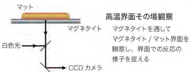
図 7 高温界面その場観察法の概略。(オンラインカラー)
