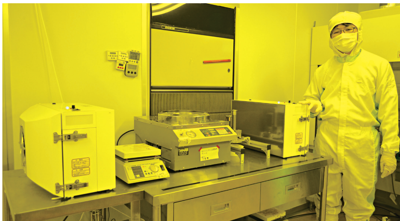
コンタミネーションのリスクの高い前処理の作業が、テーブルコーチが形成するISOクラス1の環境で行われている
