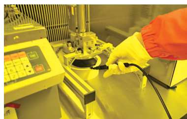
基板に付着したナノサイズの異物を除去する装置 (試作品)
